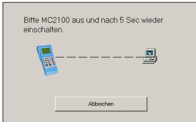
Gehen Sie sicher das vor dem Verbinden des MC2100 die temporären Daten im Gerät gelöscht sind. Sobald Sie einen Trainings oder Preisflug erfolgreich ausgelesen haben, müssen Sie die erfassten Daten im MC2100 mit dem Menüpunkt Löschen aus dem Gerät entfernen.
