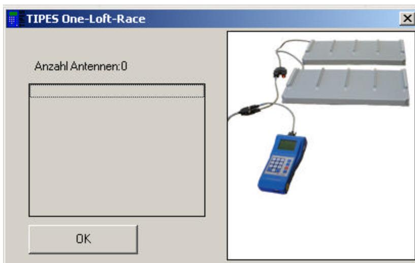
Nach dem erfolgreichen Verbinden mit dem PC gibt die OLR den Antennenstatus des MC2100 aus. Hier werden die SN und die Anzahl der Antennen ausgegeben. Nach dem erfolgreichen Anschließen können die Tauben konstatiert werden. Auf dem Screenshot sehen wir das zugeordnete Tauben mit der Verbandsnummer und dem Züchter Namen ausgegeben werden (Blau hinterlegt). Tauben die nicht in der Datenbank hinterlegt sind, werden mit der elektronischen ID des Ringes ausgegeben.
