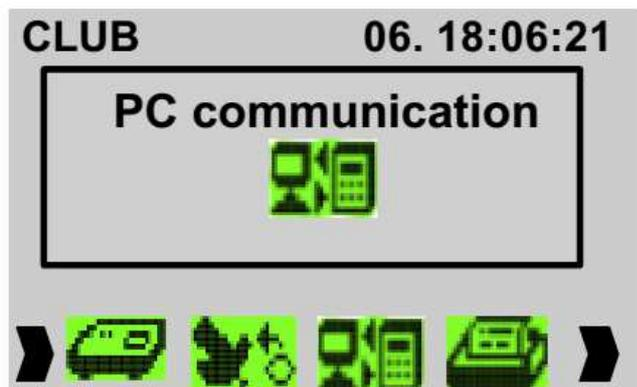
Выберите функцию «Связь с компьютером» с помощью кнопок (вправо/влево). Нажмите кнопку ВВОД. Во время получения или отправки данных МС2100 стрелка покажет направление передачи данных. Для получения подробной информации, пожалуйста, обратитесь к руководству по программному обеспечению.
